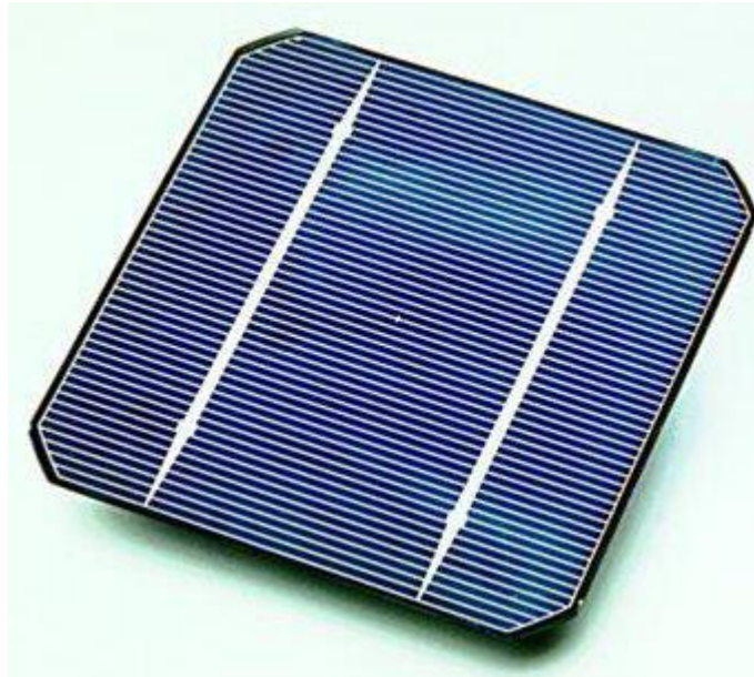
Figure (I.4) : le type de cellule monocristalline
