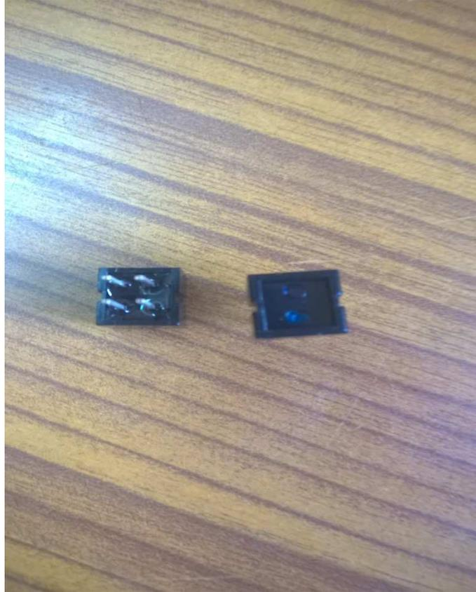
Fig.3.7 Capteur CNY70
