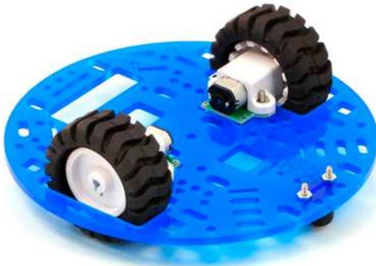
Fig.2.4 Exemple d'un châssis d'une plateforme différentielle [8]
