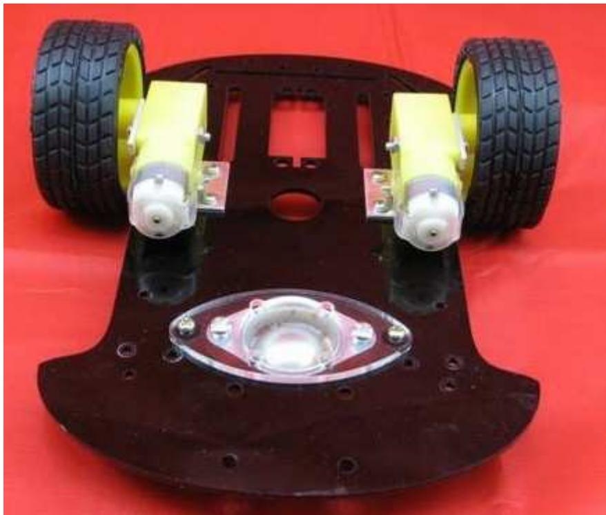
Fig.2.3 La motorisé du robot mobile
