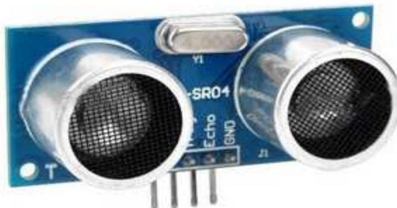
Fig.2.10 Capteur ultrason
