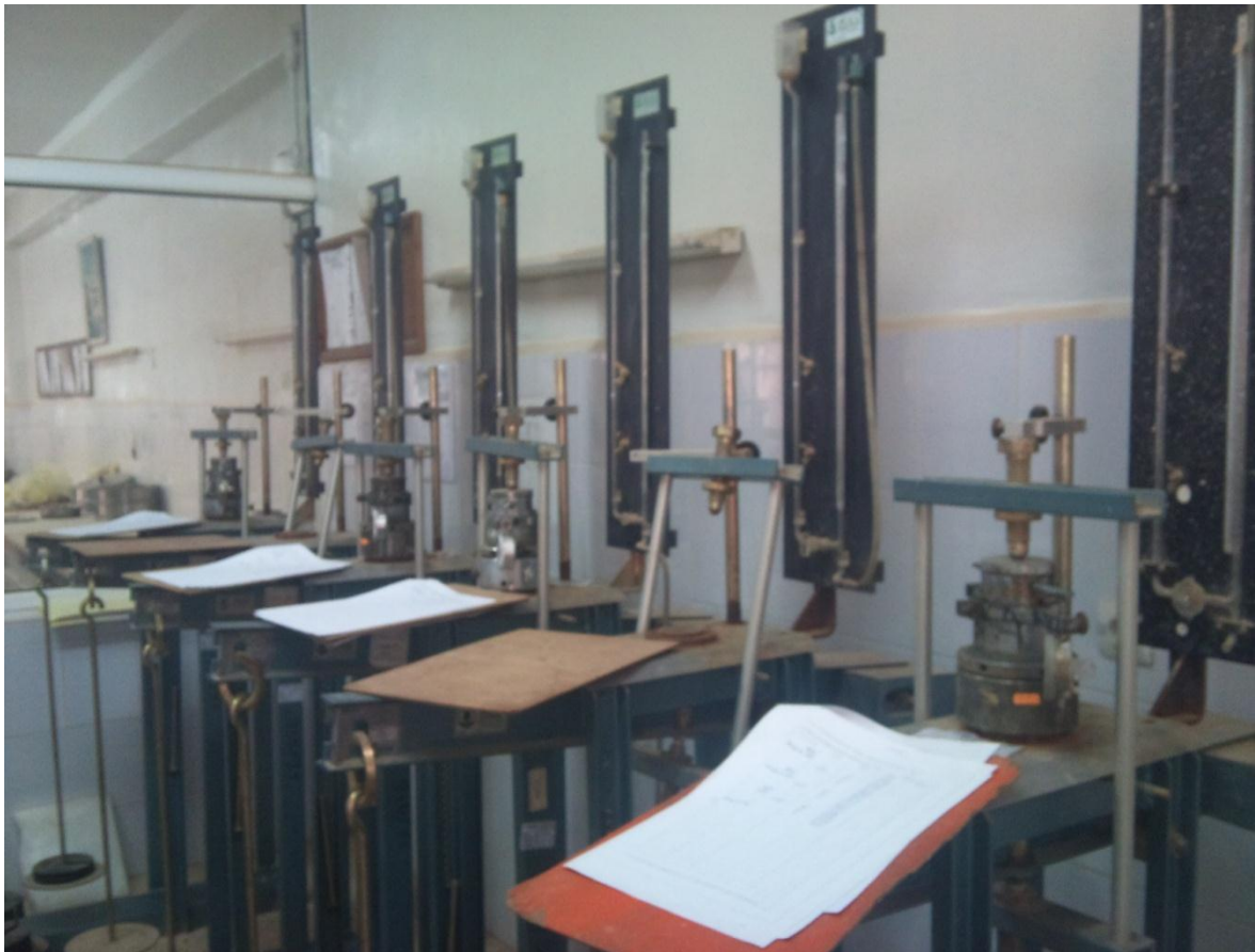
Figure 3.1: Équipement de l'essai oedométrique à LTPO Tlemcen, (2013)
