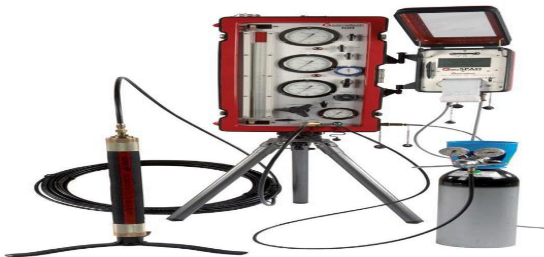
Figure 4.1 : Pressiomètre type Ménard (G100), d'après Eurogeo, (1986)
