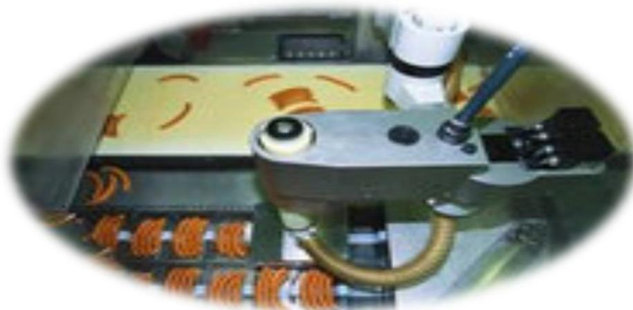
**Figure 1.8 : Robot pour conditionnement de saucisses**
