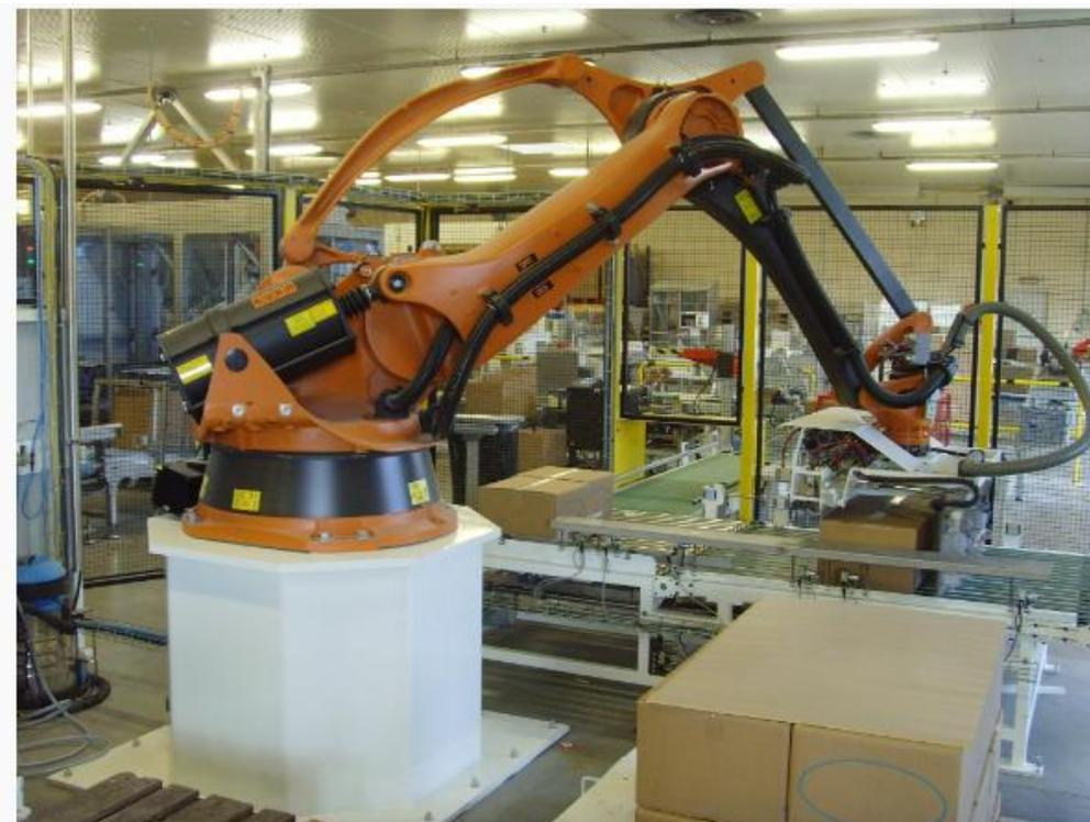
**Figure 1.3 : Un robot palettiseur des cartons**
