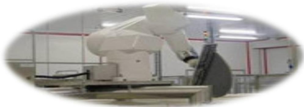
**Figure 1.6 : Robot pour tranchage lait caillé**
