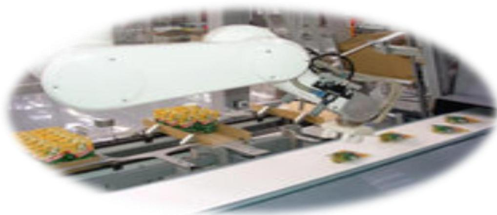
**Figure 1.10 : Robot pour conditionnement de sachets Doypack**
