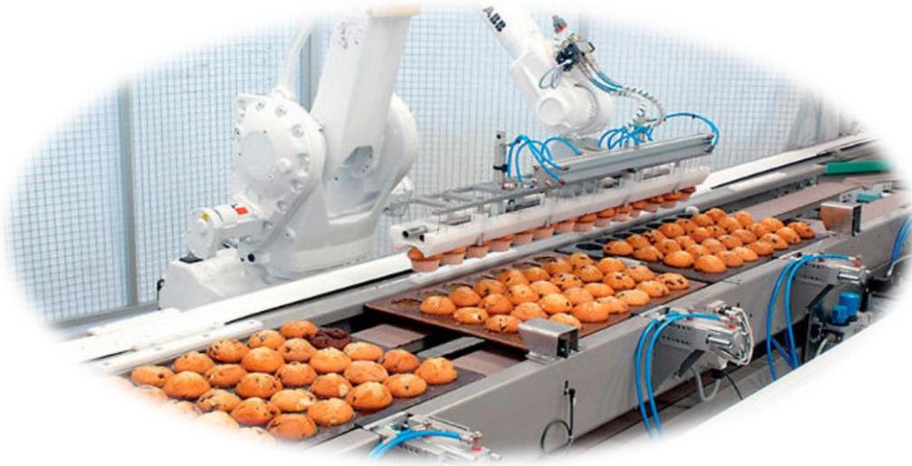
**Figure 1.7 : Robot pour déplacement des biscuits**
