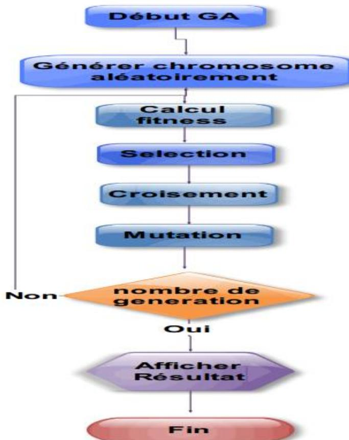
Figure II.8: Les opérations des algorithmes génétiques
