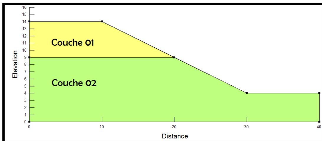
Figure 4.8 Géométrie du talus hétérogène (GEO-SLOPE, 2007).
