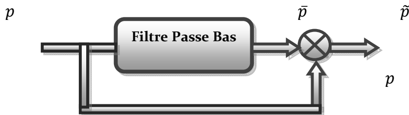
Figure II.6 structure d'un filtre passe bas
