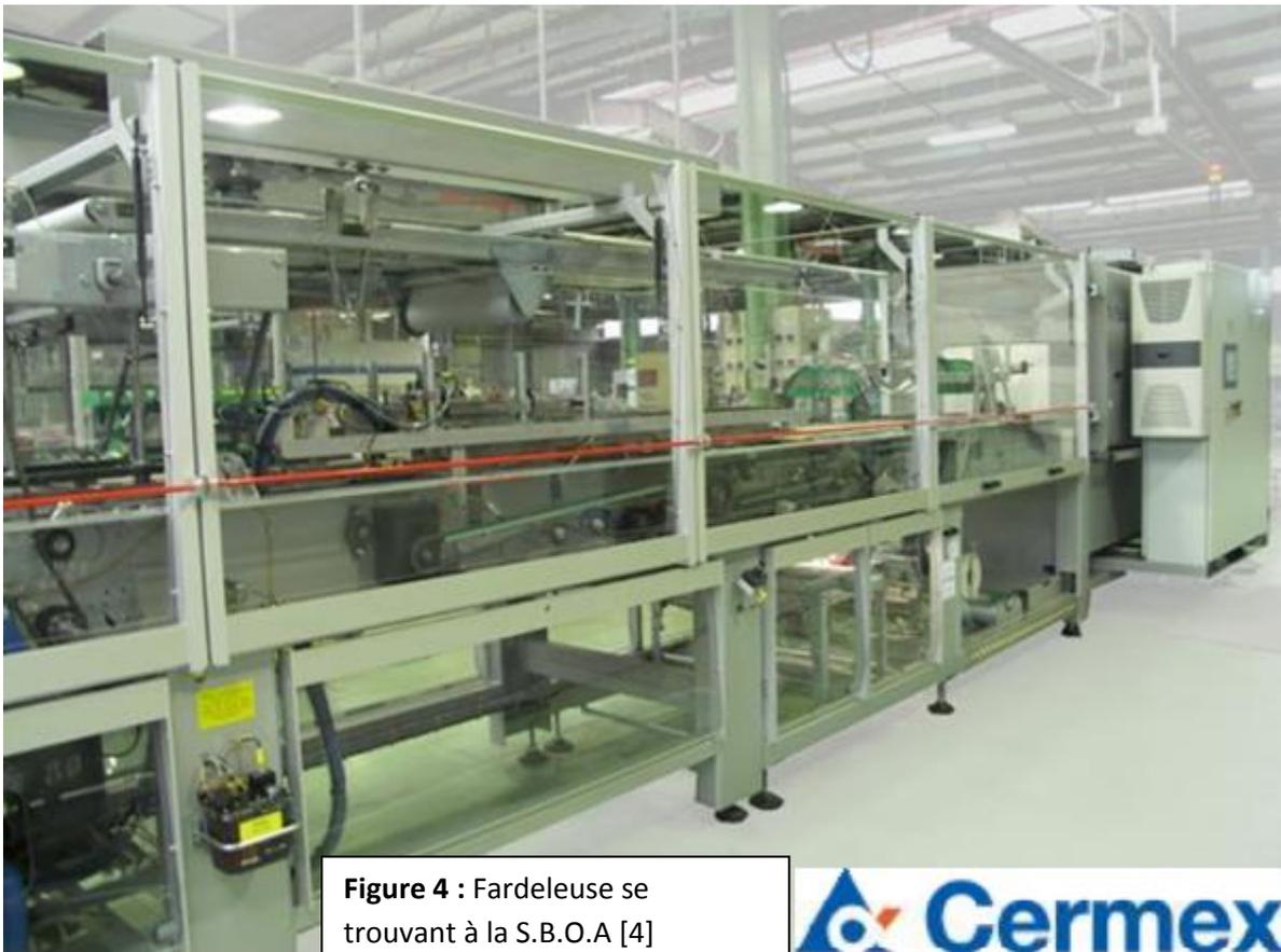
**Figure 4** : Fardeleuse se trouvant à la S.B.O.A [4]
