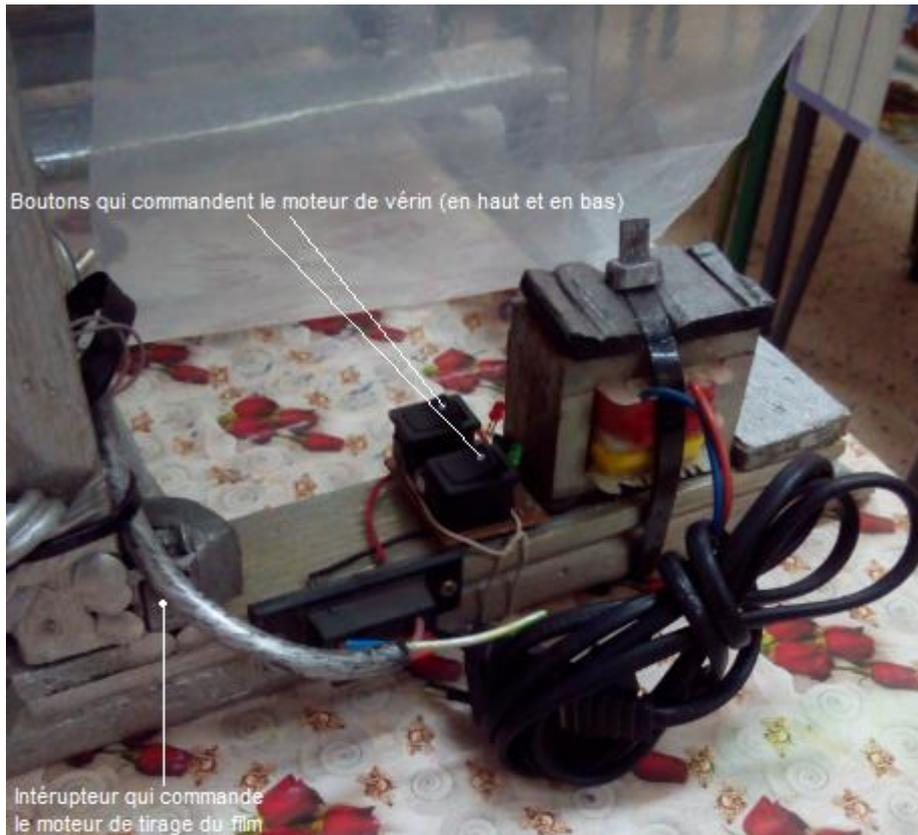
Figure 39 : Image descriptive de la partie commande. [13]
