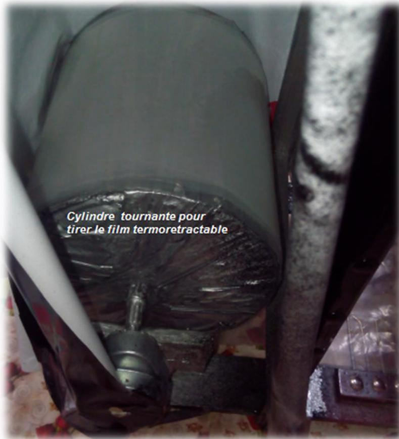
Figure 37 : Image descriptive du cylindre de tirage film. [13]
