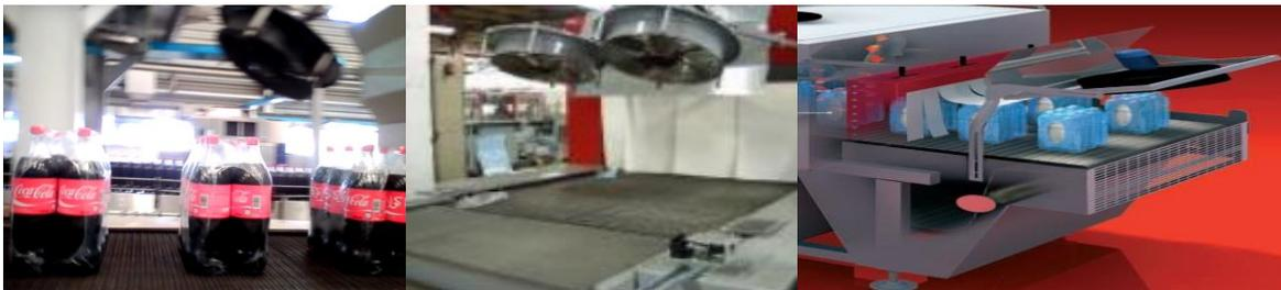
**Figure 31:** Refroidissement des fardeaux.[4 et 15]
