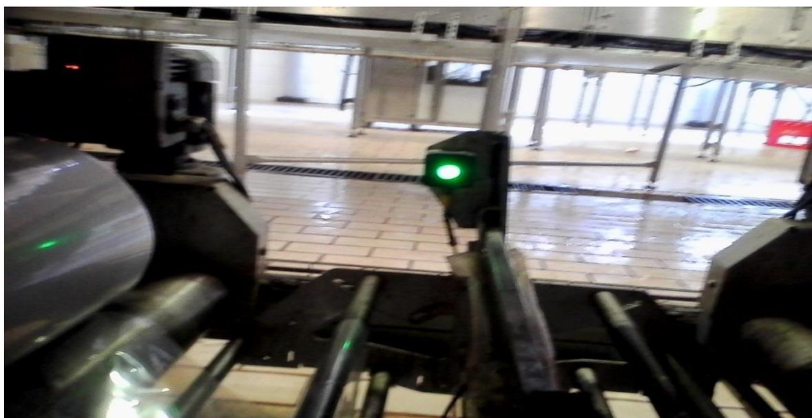
**Figure 26:** Appui sur la barre de soudure.[7]
