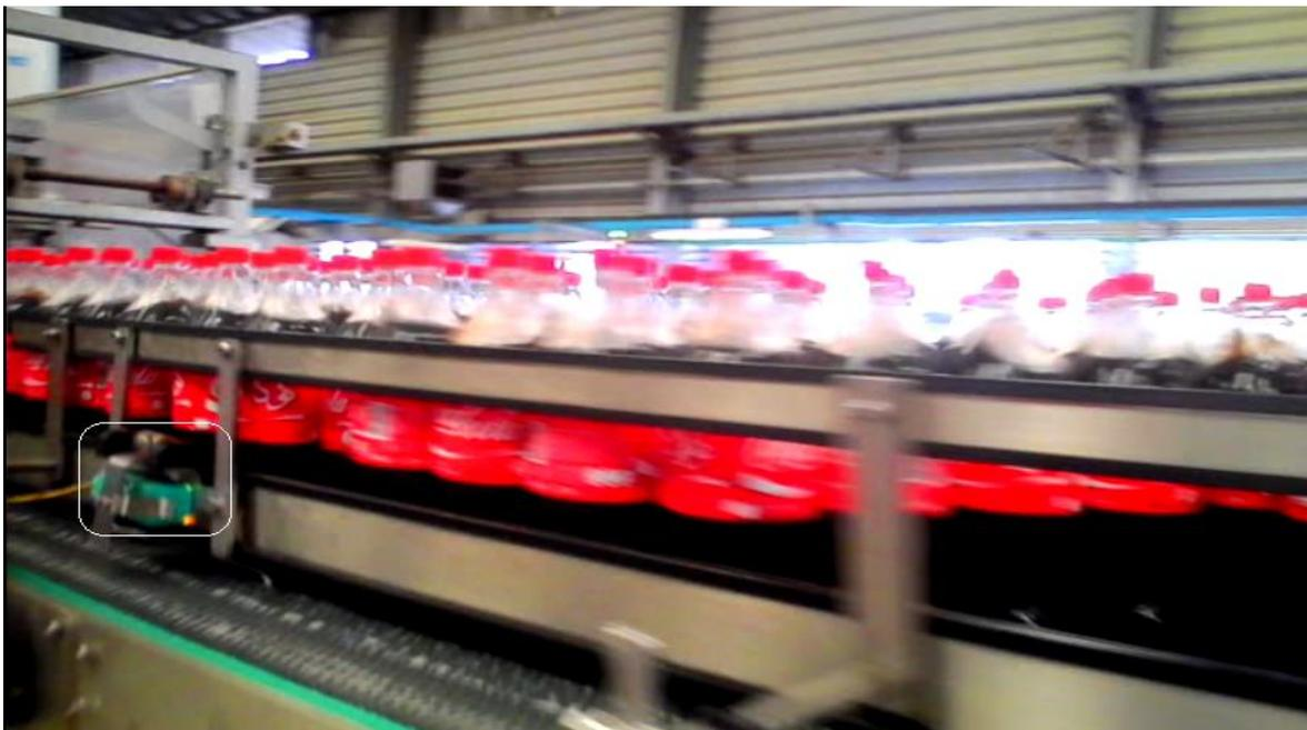
**Figure 8 :** Les capteurs photocellules.[7]
