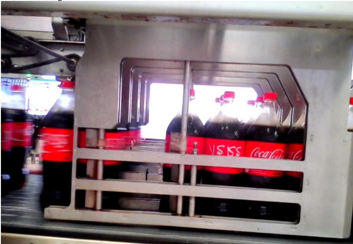
**Figure 10 :** La 2<sup>ème</sup> séparation des bouteilles.[7]
