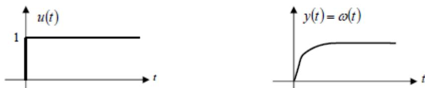
Figure .I.11 : Réponse indicielle d'un système asservi.
