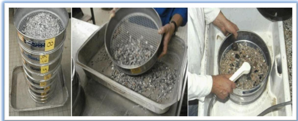
Figure 5. 1: Analyses granulométriques.[1]
