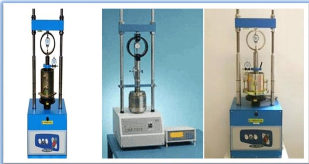
Figure 5. 6 : Essai C.B.R.[1]
