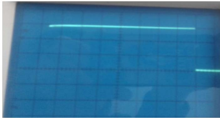
Figure 3.5 : Signal du monostable (Pin10 du IC2).
