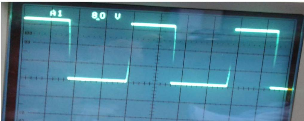
Figure 3.2 : Signal de l'astable (Pin10 du IC1).
