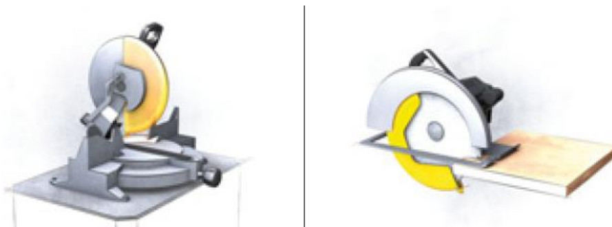
Figure I.11: Zone dangereuse en machine de coupure.
