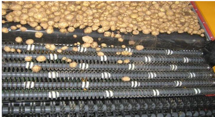
Figure 3.4 : déterreurs de produits –rouleaux en spirale -. [38]
