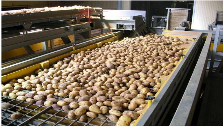
Figure 3.4 : calibreurs oscillants à grilles.[41]
