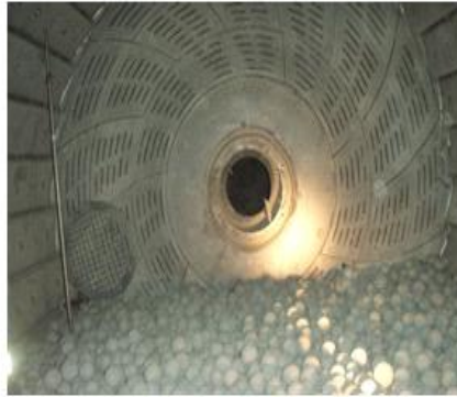
Fig. I.5. Intérieur d'un broyeur à boulets [5]
