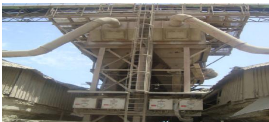
Fig.III.23. Filtre à manches (Cimenterie de Béni Saf)
