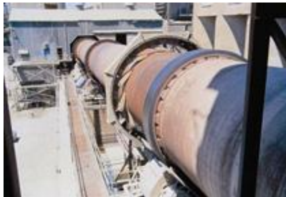
Fig. I.3. Four horizontal rotatif cylindrique en acier [13]
