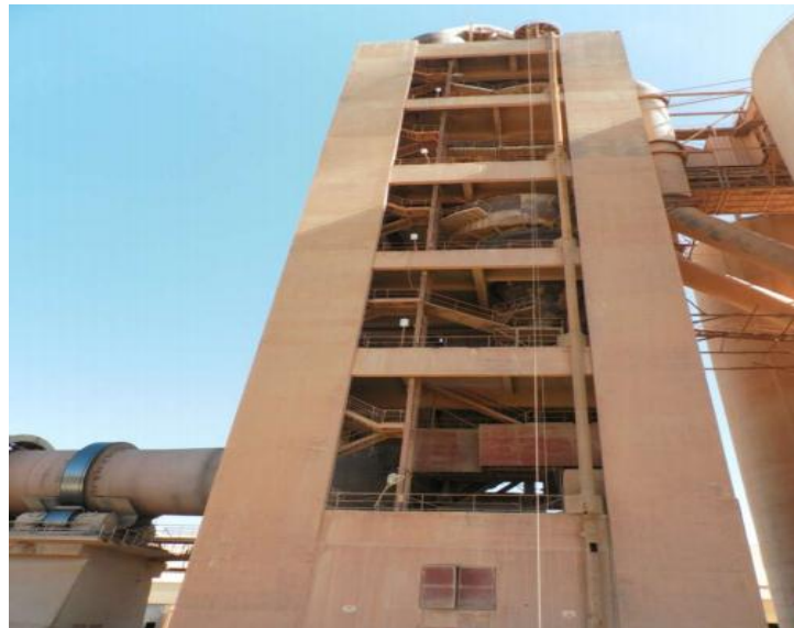
Fig.III.12 Préchauffeur (Cimenterie de Béni Saf)
