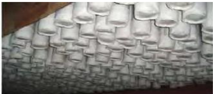
Fig. IV.18. Exemple de filtre à manches et de matière filtrante utilisés dans une cimenterie du Royaume-Uni [68]
