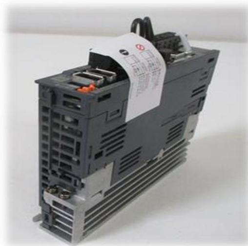
**Figure II.7 :** Servo- amplificateur MR-J4-10B-RJ
