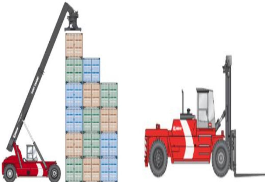
**Figure 57 :** L'équipement STACKER Spreader et élévateur
