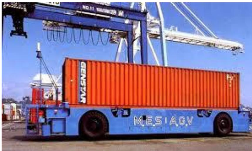
**Figure 23** : Véhicule guidé automatiquement
