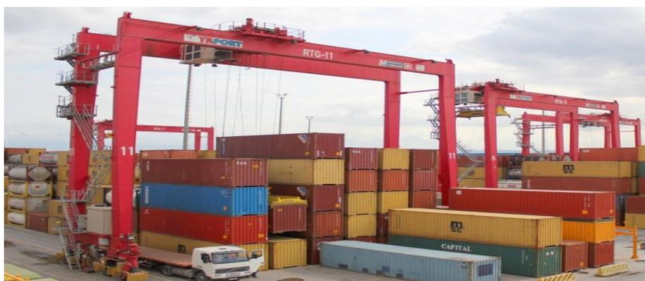
**Figure 29** : Pont roulant sur pneumatiques
