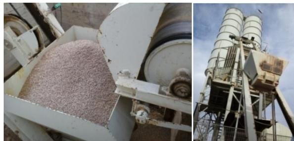
**Figure 2. 22** : Le transport des granulats vers le malaxage (photos prises par les auteurs)
