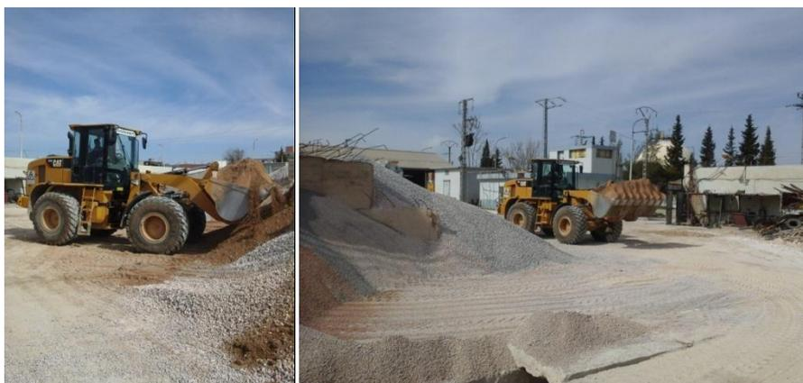
Figure 2. 4 : Le chargeur de transport des granulats (photos prises par les auteurs)
