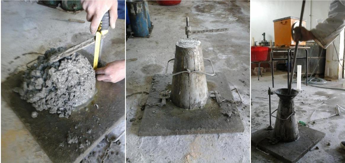
Figure 4. 2 : L'essai d'affaissement
