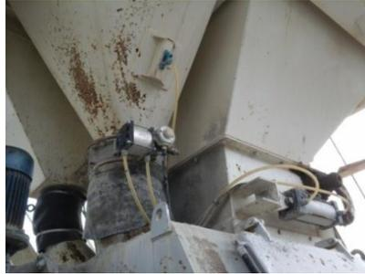
**Figure 2. 23** : Les box de l'adjuvant, l'eau et le ciment (photo prise par les auteurs)
