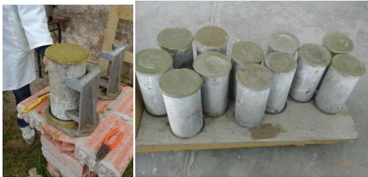
**Figure 4. 6 :** Surfaçage des éprouvettes
