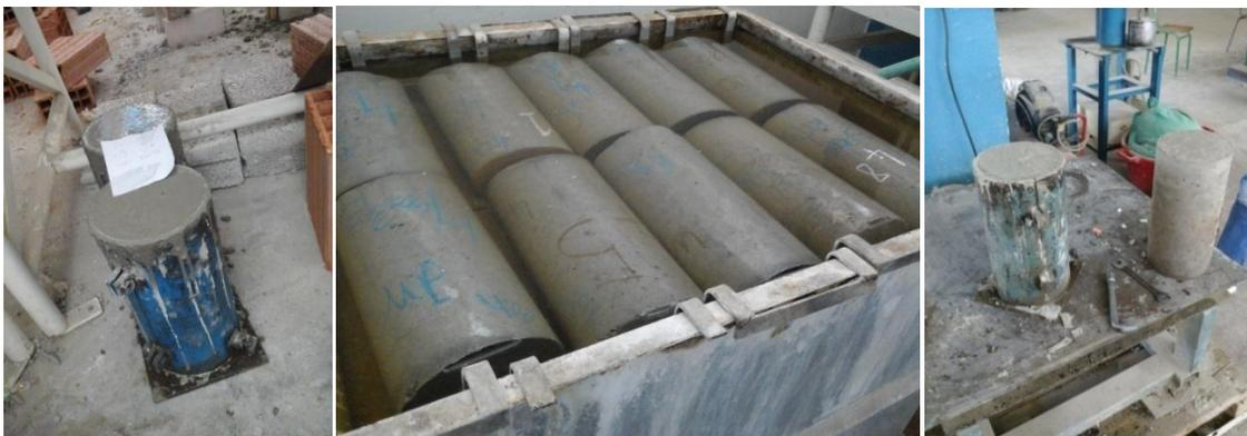
**Figure 4. 4 : Cure des éprouvettes confectionnées**
