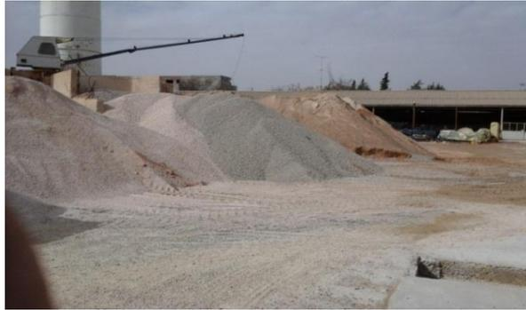
**Figure 2. 32 :** Le stockage des granulats à l'air libre (photo prise par les auteurs)
