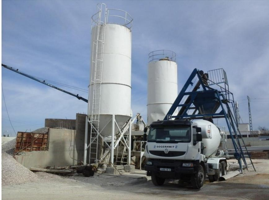
Figure 2. 26 : La centrale manuelle (photo prise par les auteurs)
