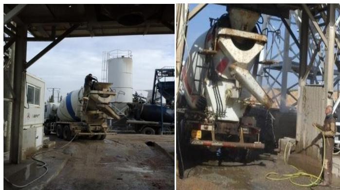
**Figure 2. 34 :** Nettoyage des camions malaxeurs (les deux centrales : Sogerhwit et Dennouni) (photos prises par les auteurs)
