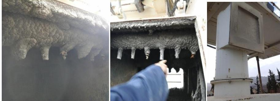
**Figure 2. 35** : Absence de nettoyage du malaxeur de la centrale automatique Sogerhwit (photos prises par les auteurs)
