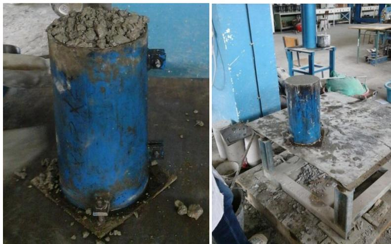
Figure 4. 3 : Confection des éprouvettes
