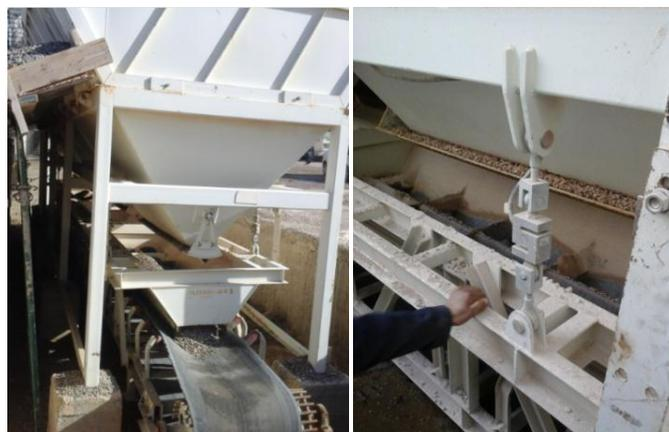
**Figure 2. 10** : Le tapis transporteur et les balances (photos prises par les auteurs)
