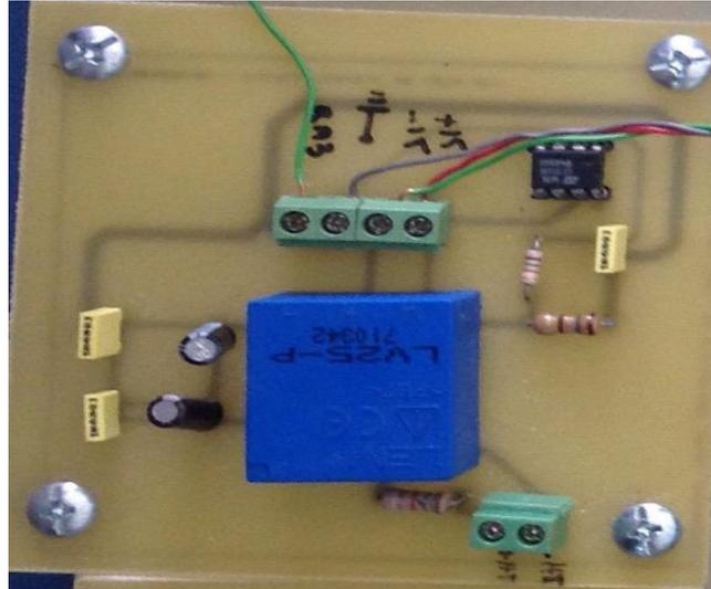
Figure II.3 - Circuit de Capteur de tension LV-25-P
