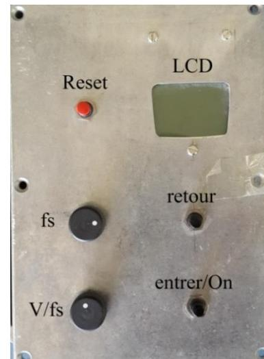
Figure III.2: Variateur de vitesse à base de dsPIC
