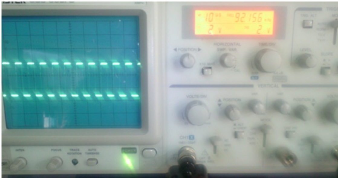
Figure VI. 9 :Le signal de sortie de diviseur par2 de CI 4013 correspondant à la position 2 de CI4518.
