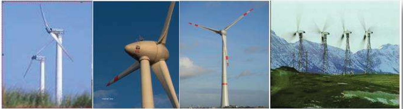
Figure I.2 : Aérogénérateur à axe horizontal.
