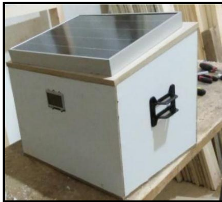
Fig 15 : glacière solaire assemblé
