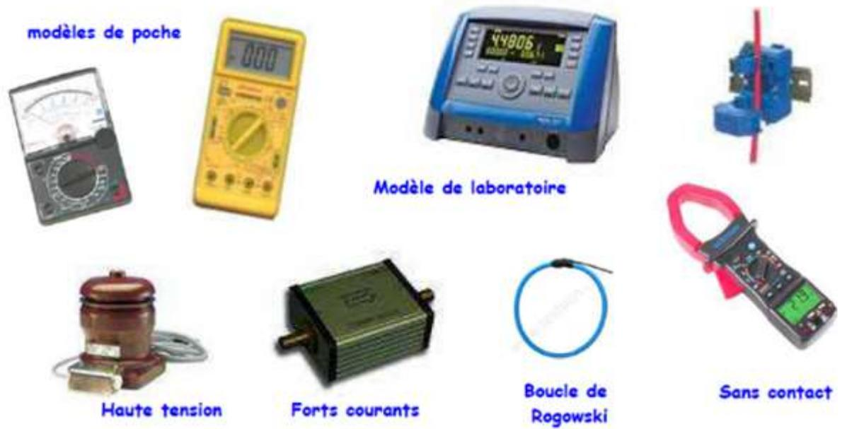
**Figure 1.11 Type de mesurande : grandeur électrique (Mesure de tension/courant).**
