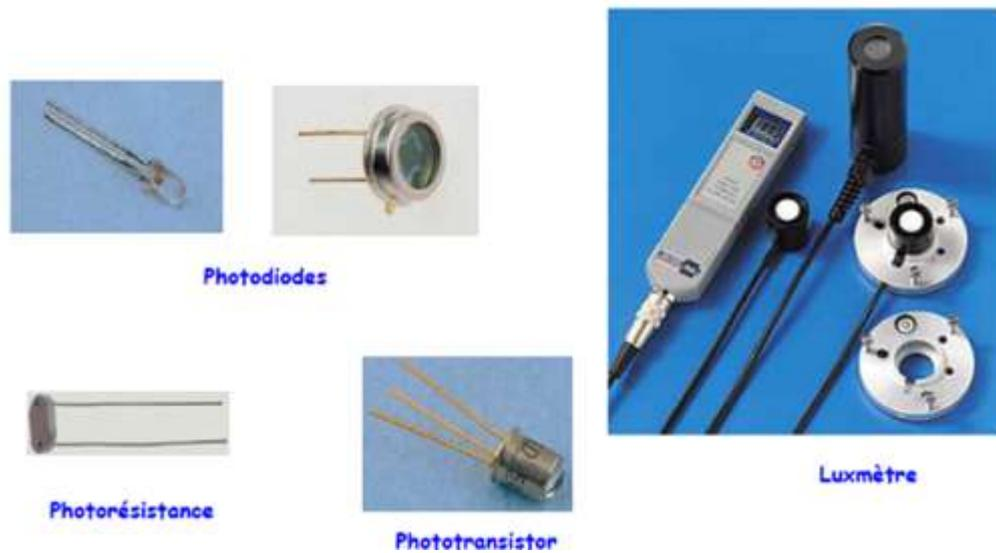
**Figure 1.12 Type de mesurande : grandeur de Rayonnement (Radiatives, Capteurs de lumière).**
