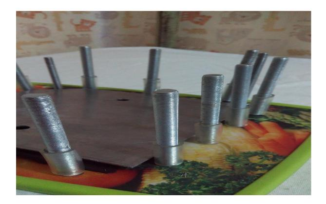
FigureIII.17 : vis + les pièces de tube
