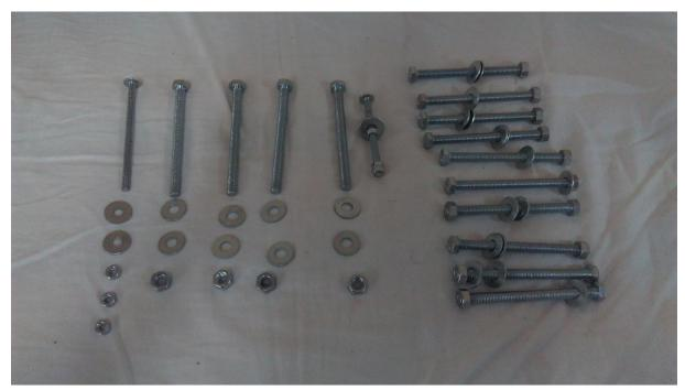
FigureIII.11: Les vis et les écrous
