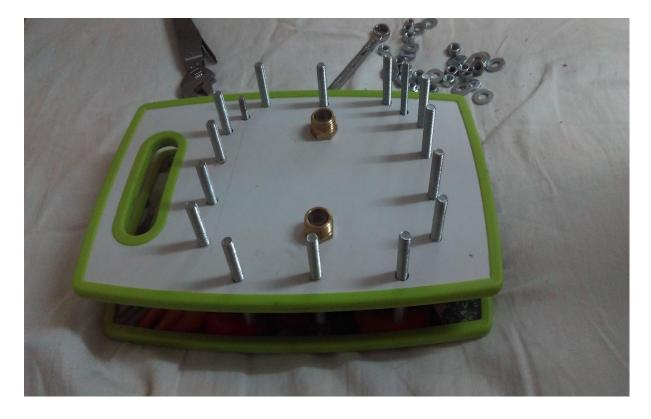
**FigureIII.22 :** On ajout la 2<sup>ème</sup> plaque de plastique pour un assemblage finale de notre générateur
