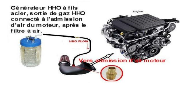
Figure III.34 : Application à un moteur de voiture
