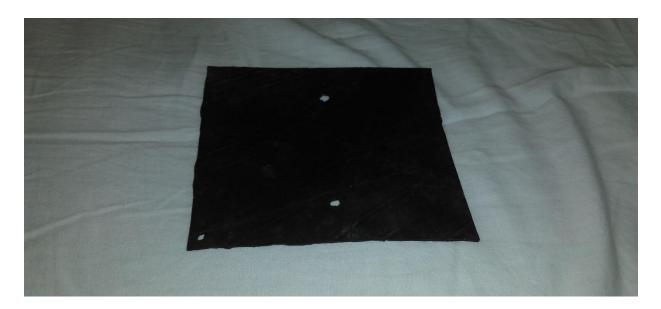
FigureIII.8 (a): Joints de caoutchouc
