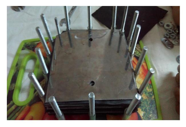
**FigureIII.20 :** On ajoute la dernière plaque inox qui joue le rôle de 2ème anode et on va fixer le dernier avec un écrou pour passer le courant
