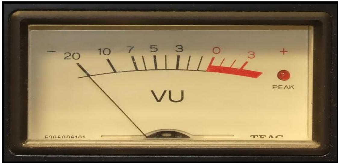
**Figure I.5 : VU-mètre à aiguille [6].**
