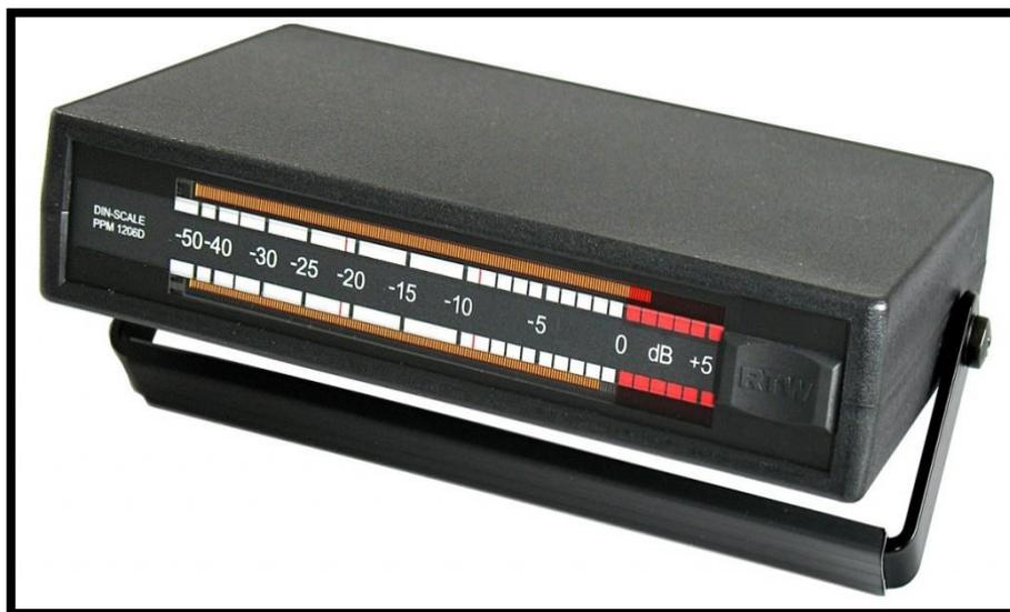
Figure I.3 Illustration d'un crête mètre [6].
