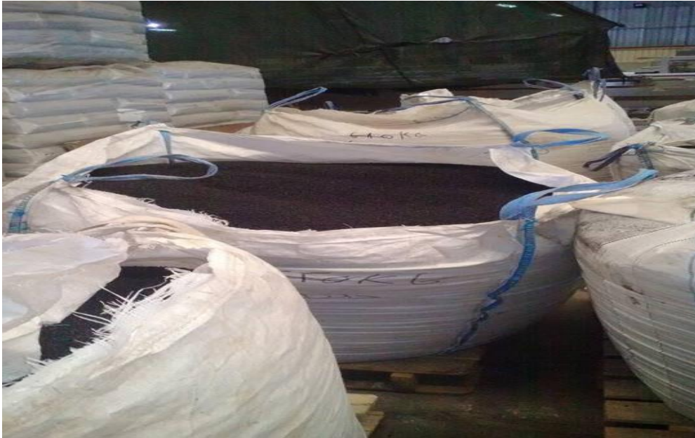
Figure 3.3: Matière première pour la production du tube PEHD.
