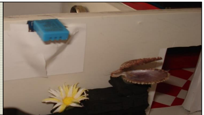
Figure III. 10: Montage réel de DHT 11
