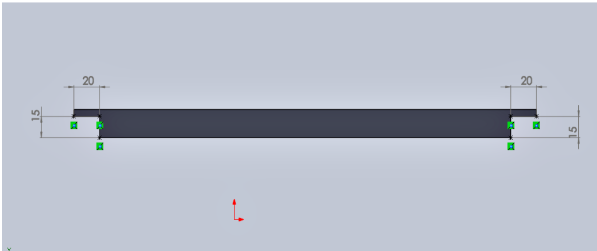
Figure.III.15 : Pièce de face arrière avec enlèvement de matière
