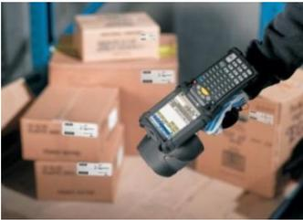
Dans les magasins et usines qui possèdent des stocks, la *RFID* est le moyen d'analyser rapidement les flux. Le système informatisé permet d'avoir une trace des flux : du stock jusqu'à la vente. La caisse communique avec l'ordinateur mettant ainsi à jour la liste du stock.
