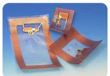
étiquette qui émet des ondes radio. C'est une technologie d'identification automatique au même titre que le code à barres
