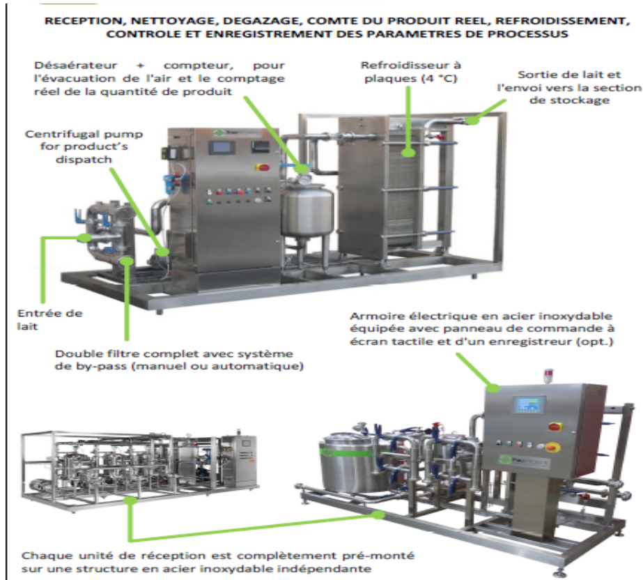
Fig. II.3 : Station de sélection et de réception
