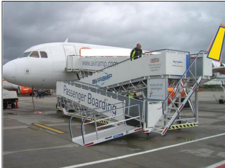
Figure II.9 - Ligne de transfert adaptée à la circulation et l'accès des PMR aux avions
