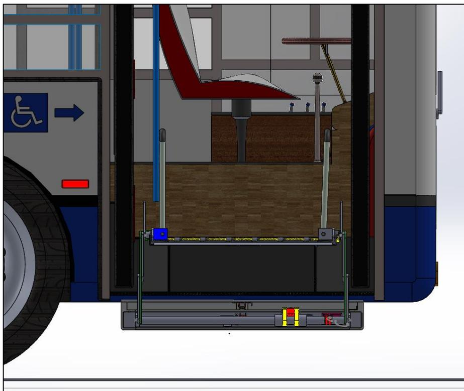
**Figure IV.71 :** Plateforme installée à l'autobus – vue ombrée –
