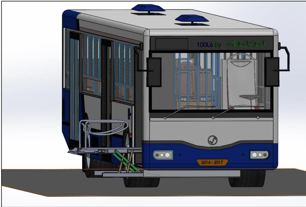
**Figure IV.69 :** Plate-forme installée à l'autobus – position plancher -
