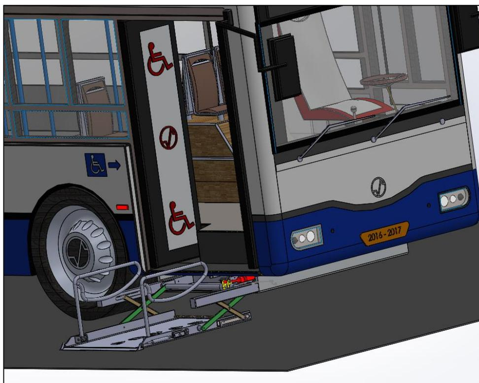
**Figure IV.72 :** Plateforme installée à l'autobus – position Sol -
