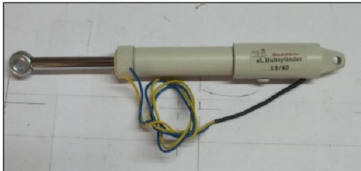
Figure IV.25 : Vérin électrique (motoréducteur)
