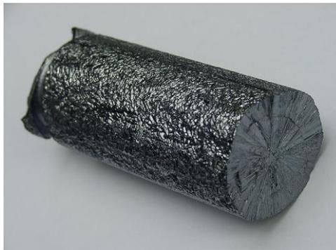
**Figure 5** : Barreau de silicium poly cristalline. [23]
