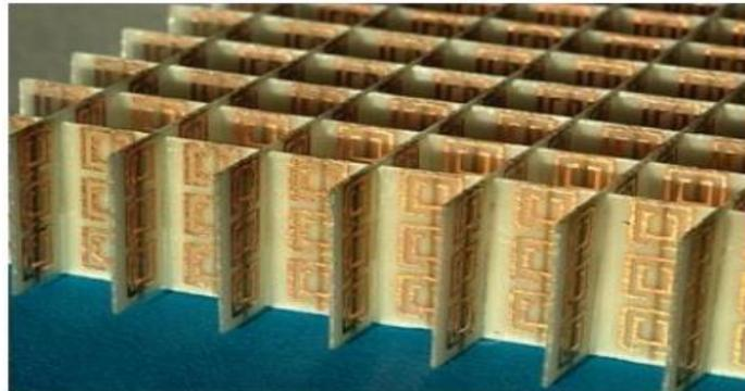
Figure I.2 Un métamatériau doublement négatif bidimensionnel.
