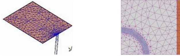
Figure III.1 Exemples de maillages adaptatifs utilisés en FEM.
