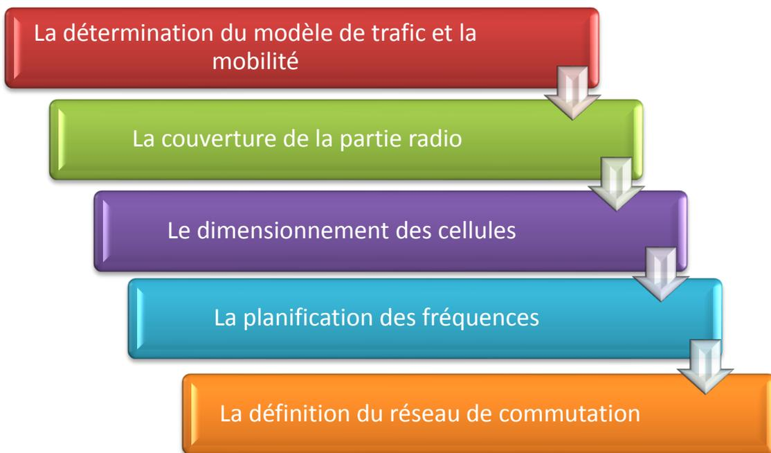
**Figure IV.1 : processus de planification des cellules**
