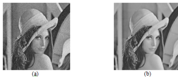
FIGURE 2.8 – (a) :Image bruitée (impulsionnel 20%). (b) :Coupe Médiane 5x5 sur bruit impulsionnel.
