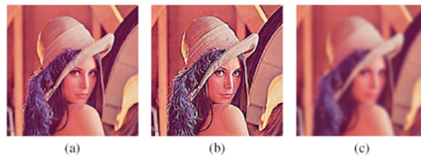
FIGURE 2.6 – Exemple de filtres passe-haut et passe-bas. (a) Image Lena d'origine. (b) Image après filtrage passe-haut. (c) Image après filtrage passe-bas.
