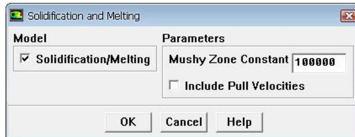
Fig.4.9. Définition du modèle de solidification.
