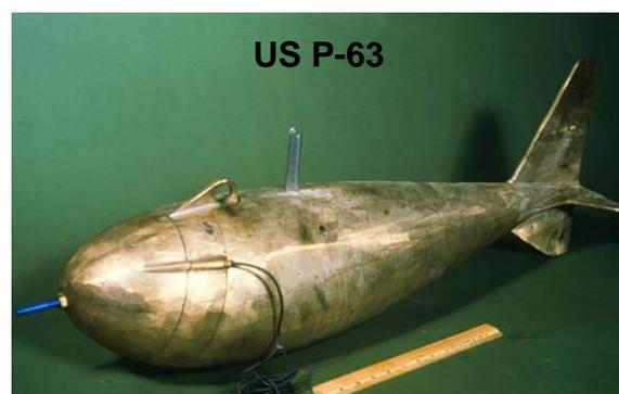
**Figure. A.21. Échantillonneur à intégration par point.**
