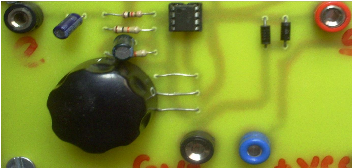
Figure 35 : l'abaisseur de tension.
