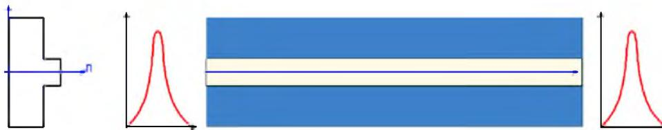
Figure 1.11 Propagation du mode fondamental dans une fibre monomode
