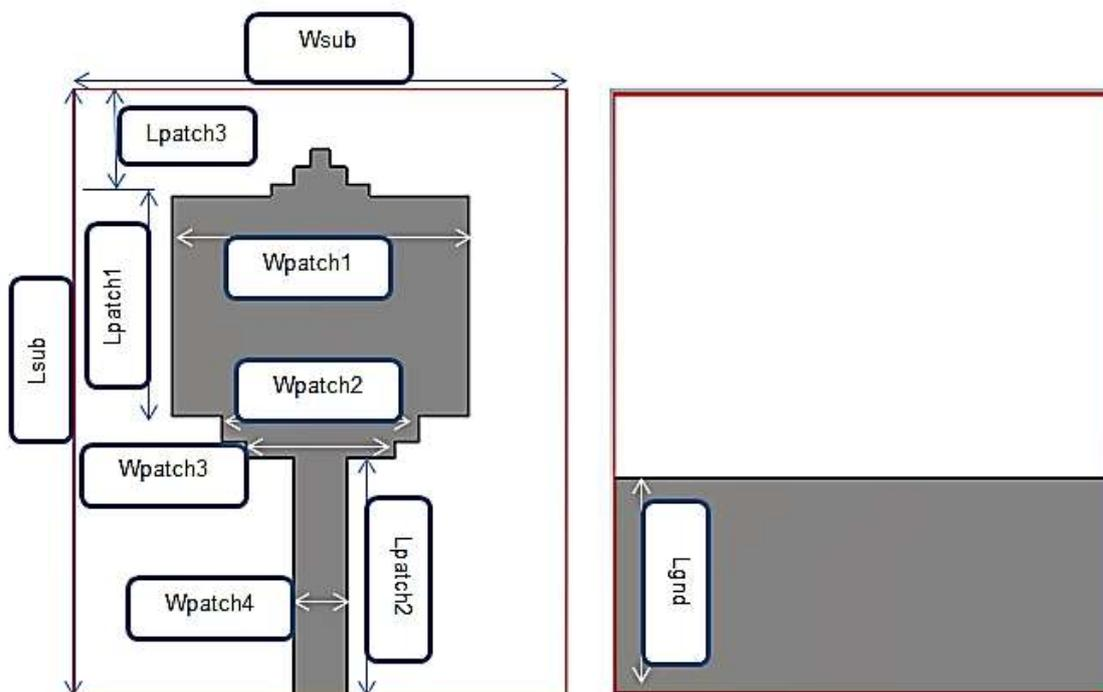
Figure IV.1 : géométrie d'antenne simulée
