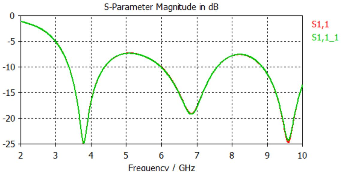
Figure IV.45 Représentation des deux Coefficients de réflexion
