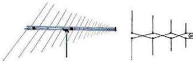
**Figure II. 8 : Réalisation pratique de l'antenne LPDA et de son alimentation.**
