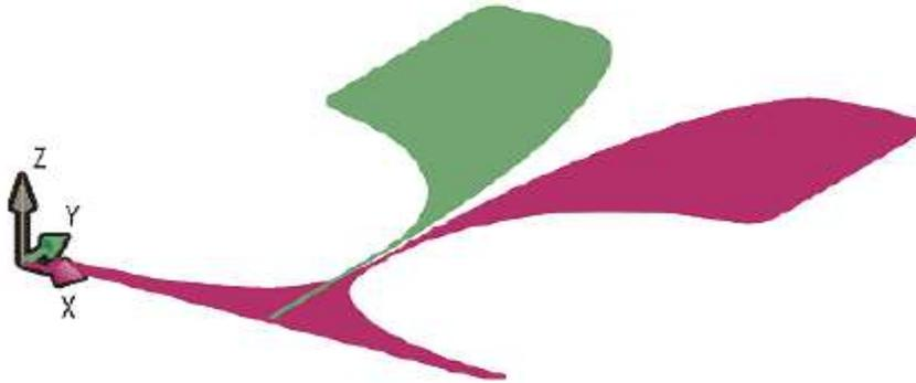
**Figure II. 16 : Antenne Vivaldi antipodale**
