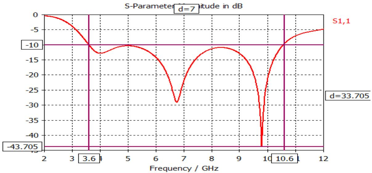
Figure IV.7 : Représentation du Coefficient de réflexion
