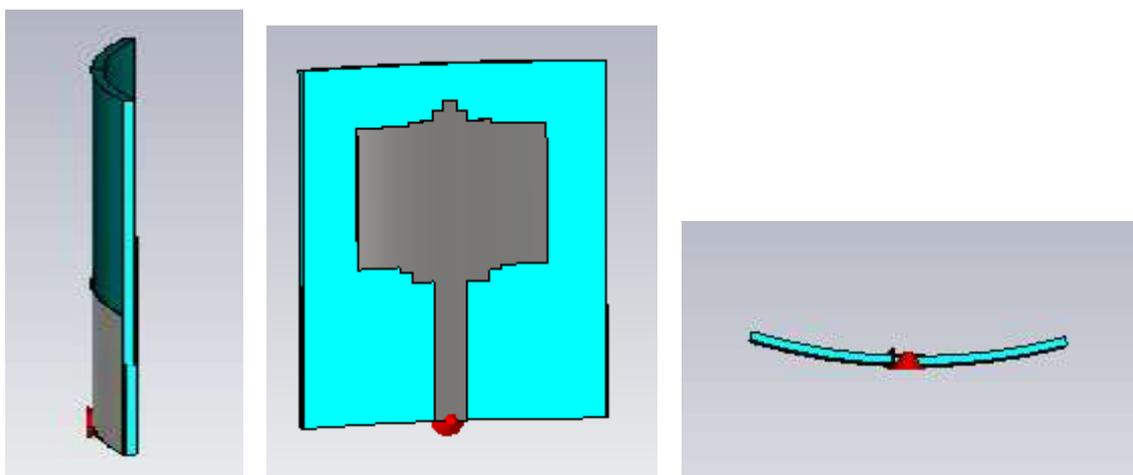
Figure IV.25 : Patch conformée excité par un port discret
