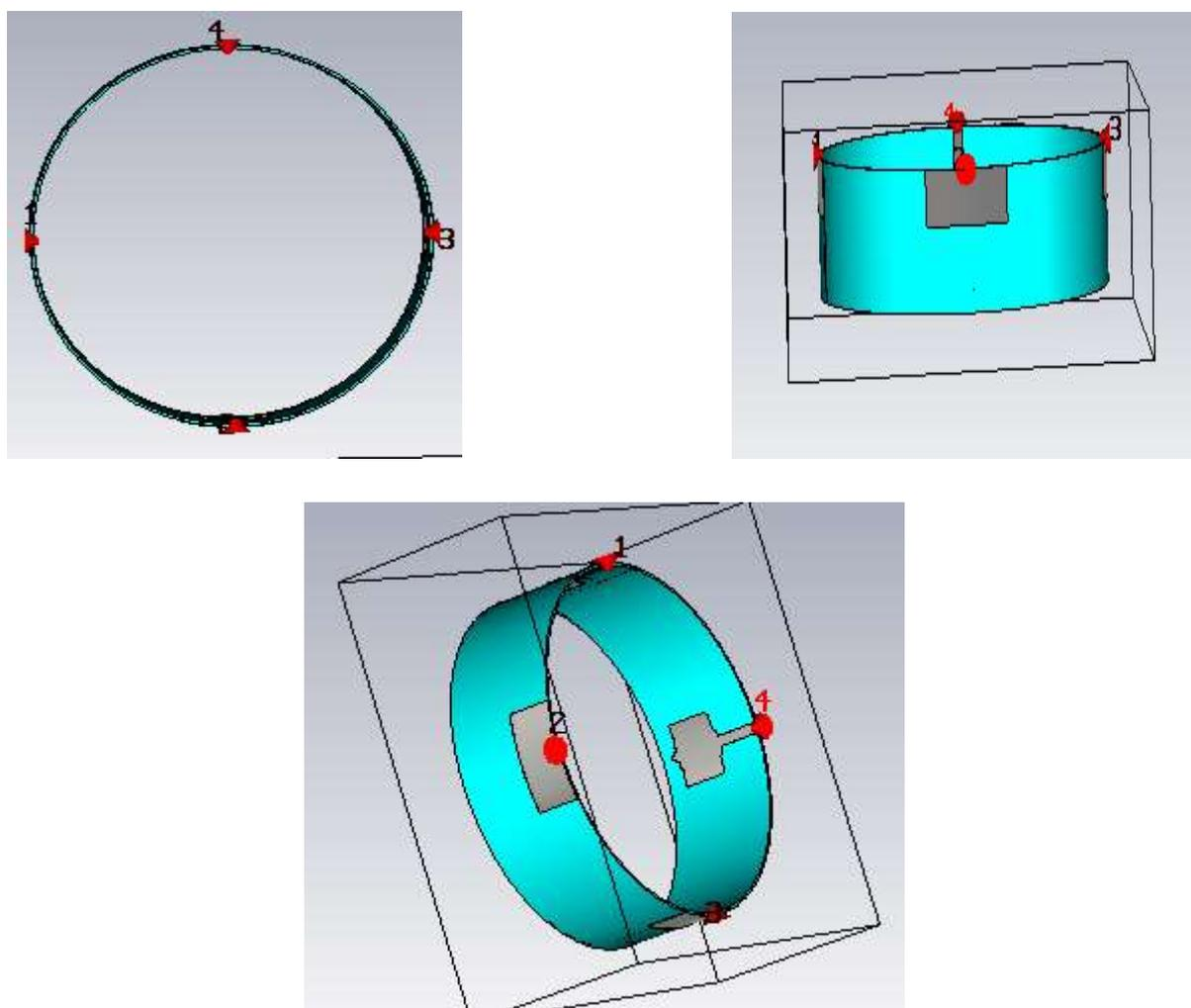
Figure IV.40 : Présentation du Réseau de 4 antennes
