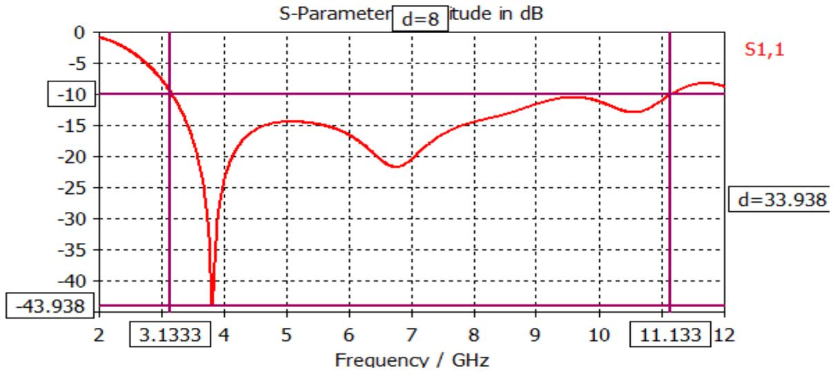
Figure IV.9 Représentation du Coefficient de réflexion S11
