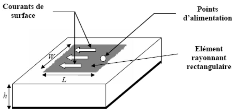
Figure I. 3 : Antenne imprimée rectangulaire alimentée en un point
