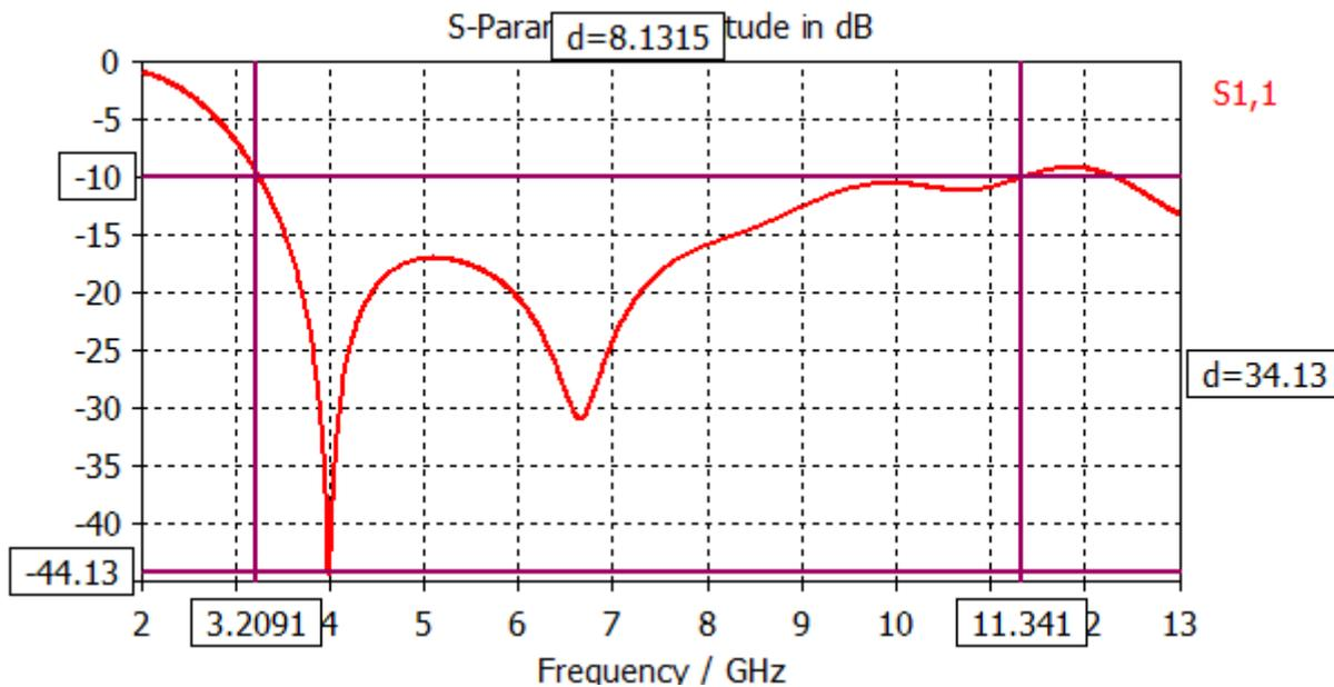
Figure IV.3 : Représentation du Coefficient de réflexion  $S_{11}$
