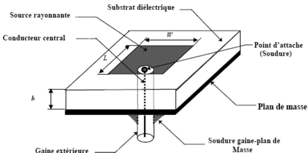
**Figure I. 6 : Alimentation par sonde coaxiale**
