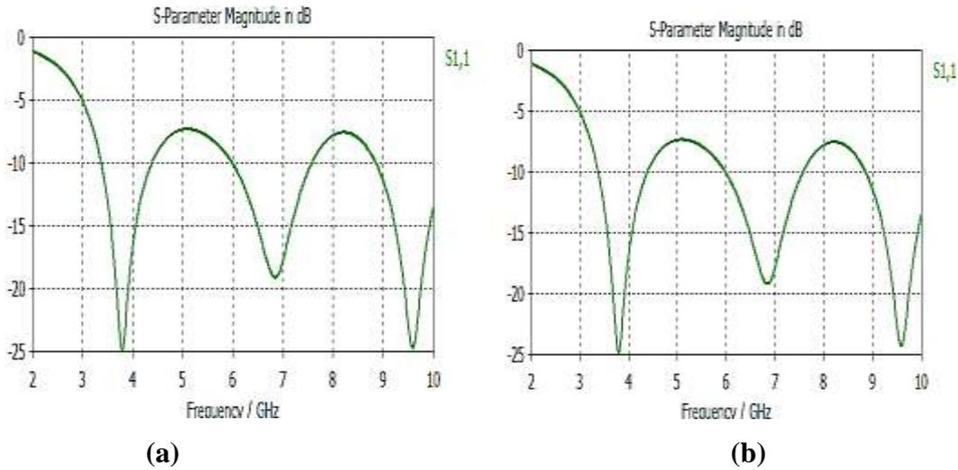
Figure IV.44 Représentation du coefficient de réflexion S11
