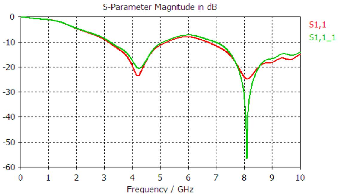
**Figure IV.34 :** Représentation des deux Coefficients de réflexion  $S_{1,1}$  Avec tumeur et  $S_{1,1}$  Sans tumeur
