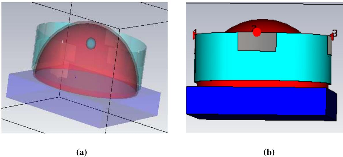
Figure IV.43: Antenne avec élément biologique
