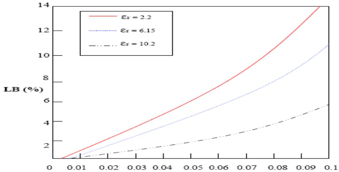
**Figure I. 10 : Largeur de bande (%) d'une antenne plaque rectangulaire en fonction de l'épaisseur du substrat pour plusieurs constantes diélectriques du substrat [5]**
