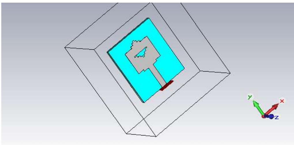
Figure IV.8 : antenne avec ouverture
