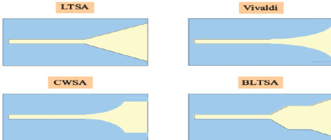
**Figure II. 15 : Différents types d'antennes TSA**
