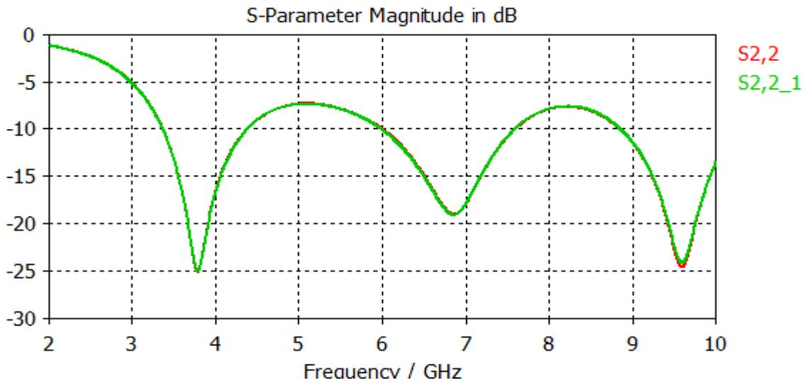
Figure IV.47 Représentation des deux Coefficients de réflexion
