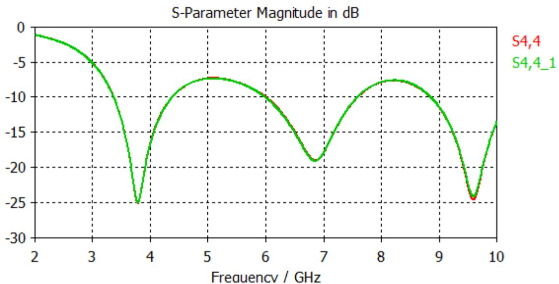
Figure IV.51 Représentation des deux Coefficients de réflexion
