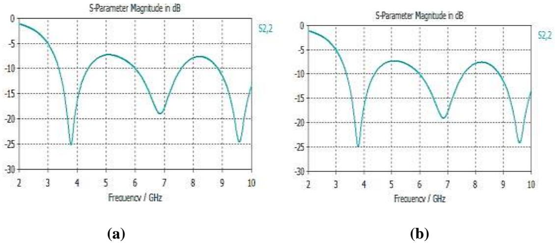
Figure IV.46 Représentation du coefficient de réflexion  $S_{2,2}$
