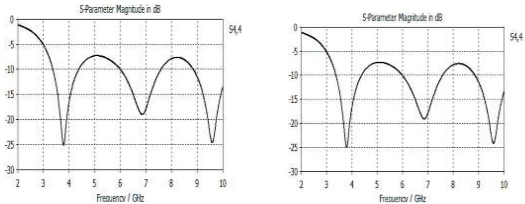
Figure IV.50 Représentation du coefficient de réflexion S44
