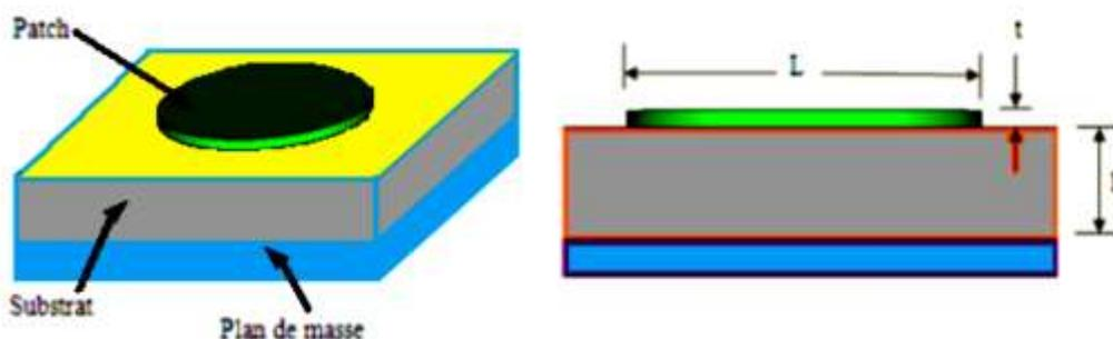
**Figure I. 1 : Présentation d'une antenne patch à élément circulaire**
