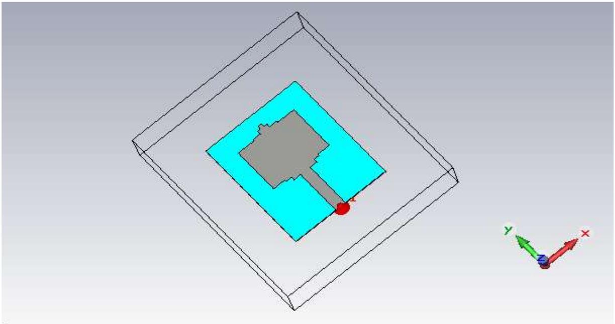
**Figure IV.6 : Antenne excitée par un port discret**
