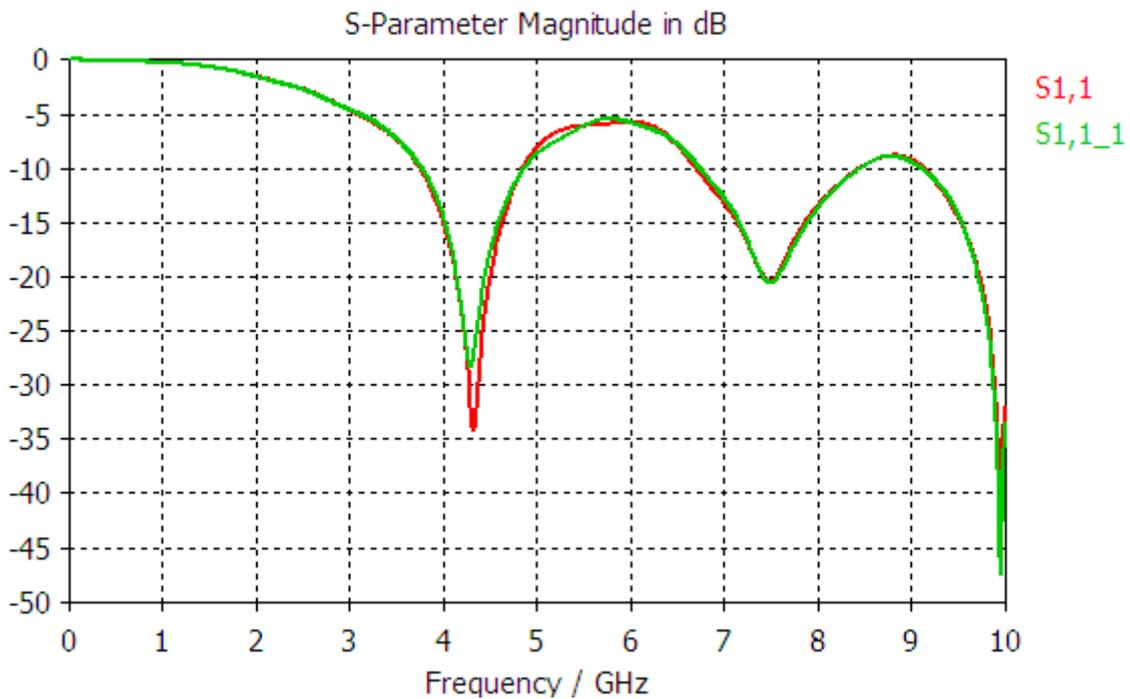
**Figure IV.38 : Représentation des deux Coefficients de réflexion  $S_{1,1_1}$  Avec tumeur et  $S_{1,1}$  Sans tumeur**
