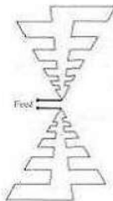
Figure II. 7 : Antenne log-périodique de forme trapézoïdale
