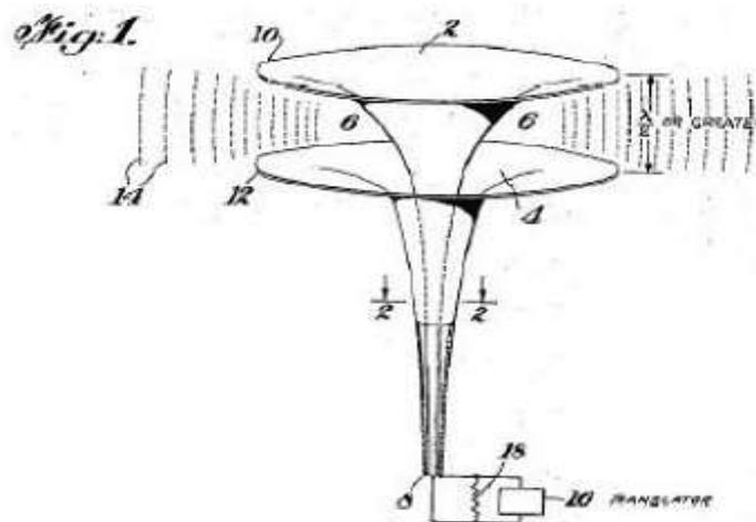
Figure II. 14 : Représentation du cornet omnidirectionnel
