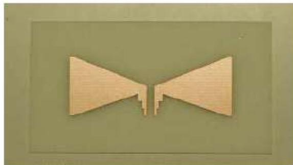
Figure II. 11 : antenne papillon
