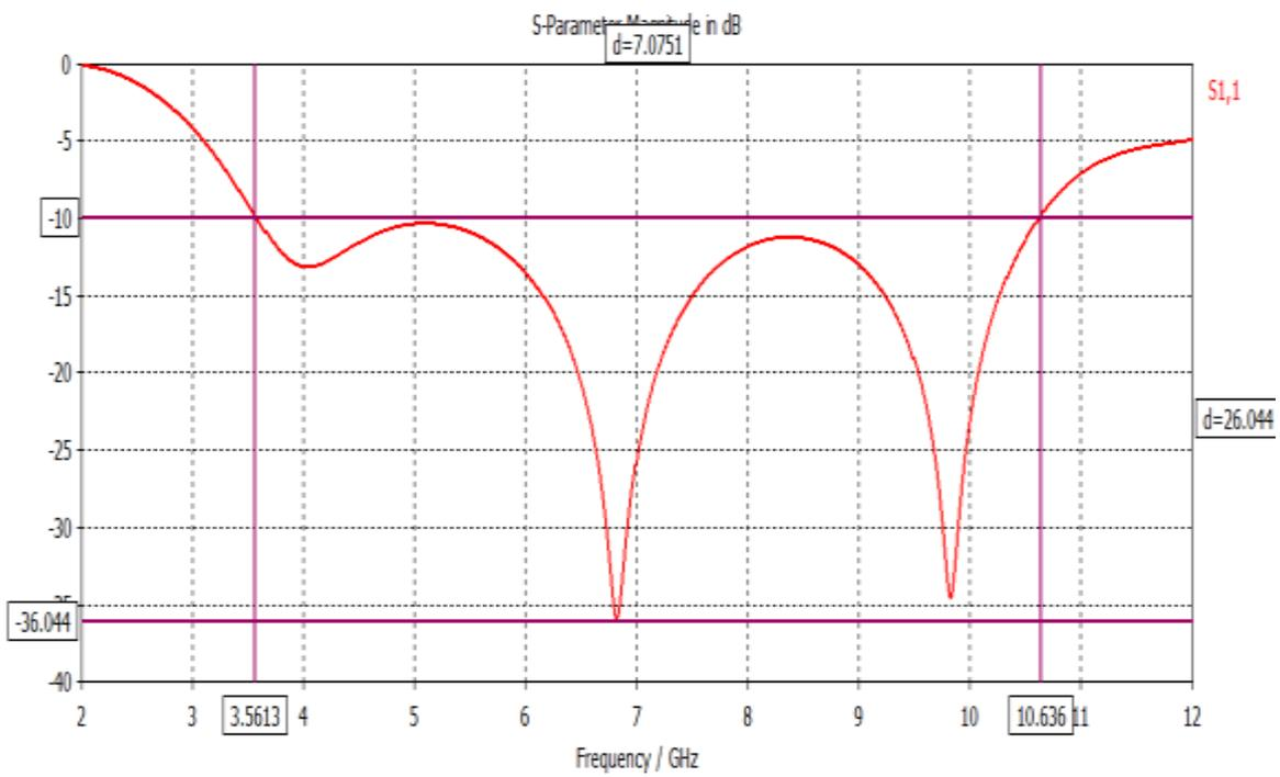
Figure IV.26 : Représentation du coefficient de réflexion
