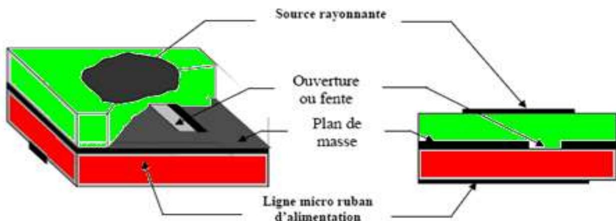
Figure I. 7 : Alimentation couplée par fente
