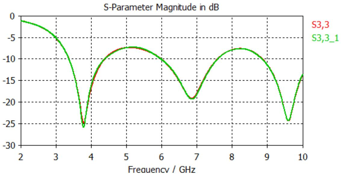
Figure IV.49 Représentation des deux Coefficients de réflexion
