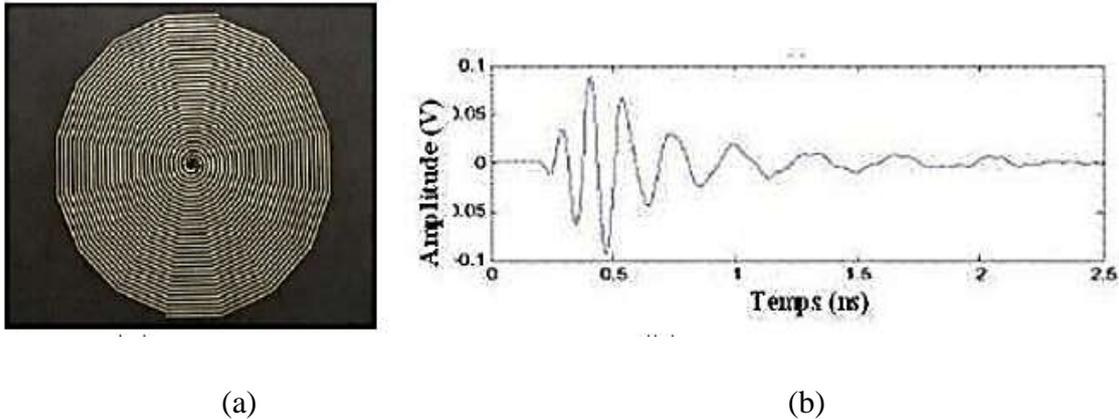
**Figure II. 4: (a) Antenne spirale d'Archimède (b) Impulsion rayonnée de l'antenne spirale Archimède dans le plan E**
