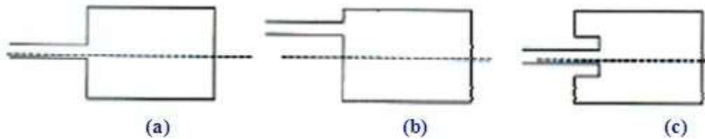
**Figure I. 5 : Différents types d'alimentation par ligne Micro ruban**
