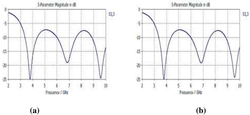
Figure IV.48 Représentation du coefficient de réflexion S33
