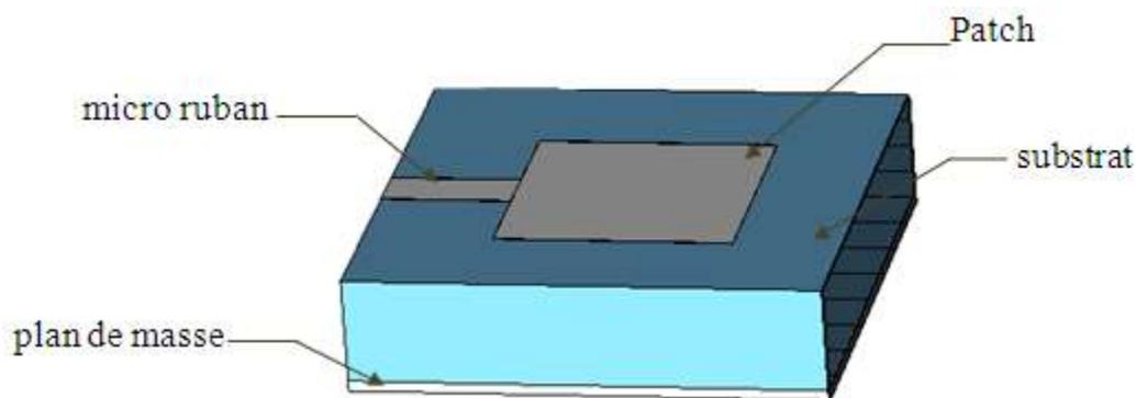
Figure I. 4 : Alimentation par ligne Micro ruban
