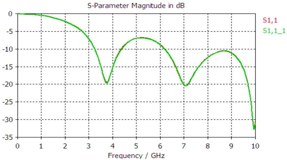
**Figure IV.30 :** Représentation des deux coefficients de réflexion
