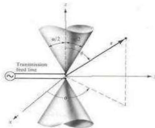
Figure II. 9 : Antenne biconique infinie.
