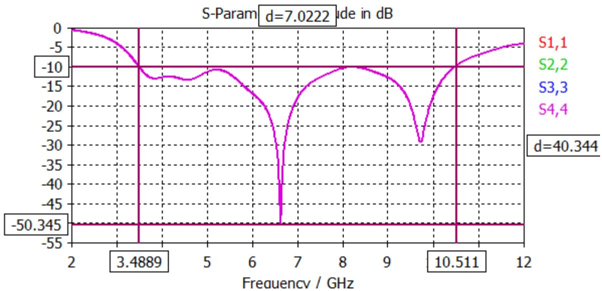
Figure IV.41 Représentation des Coefficient de réflexion S11, S22, S33, S44
