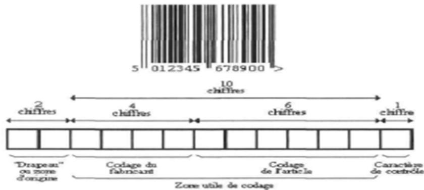
**FIG 1.2 : Exemples d'un code à barres à EAN 13 chiffres. [4]**
