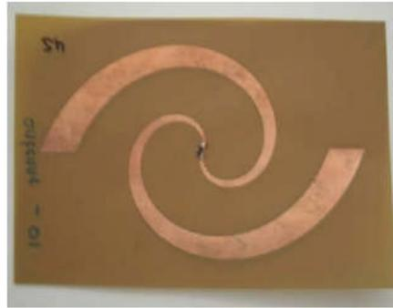
FIG 2.10 : antenne spirale. [28]
