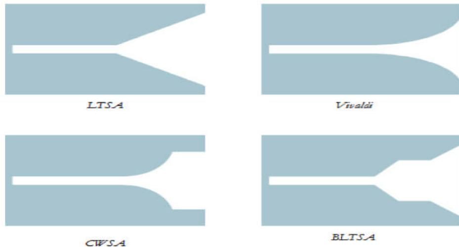
FIG 2.9: Les différents profils des antennes TSA. [45]
