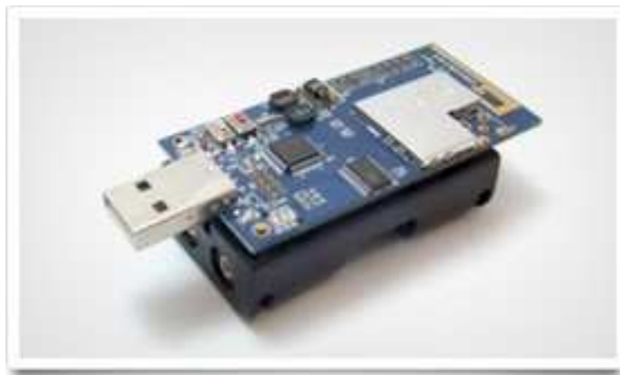
Figure IV.5 Spécifications de capteur MTM-CM5000MSP .
