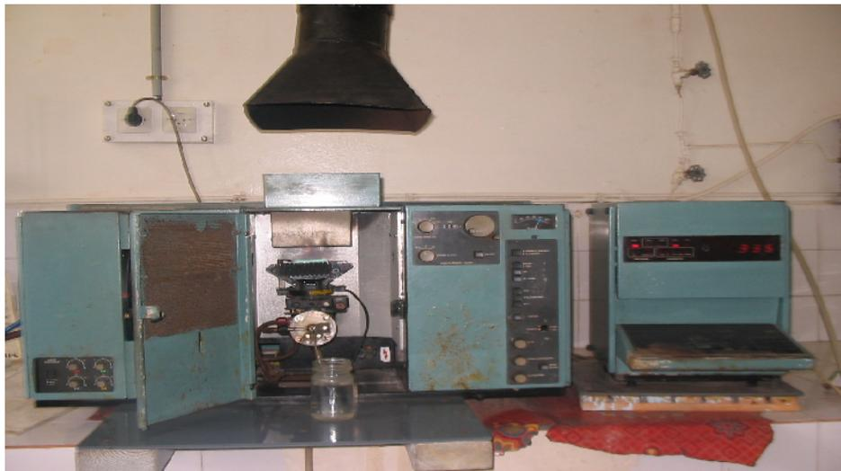
**Figure .2: Photo de l'appareil d'absorption atomique**
