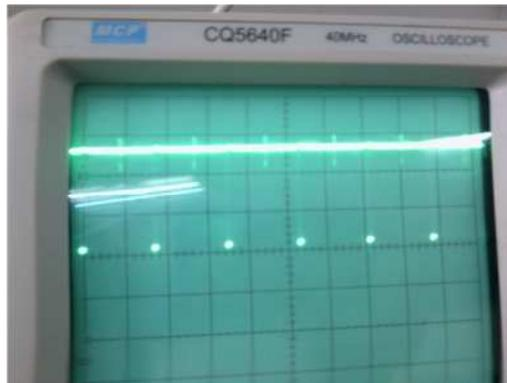
Figure 4.16 : l'impulsion de fin de conversion
