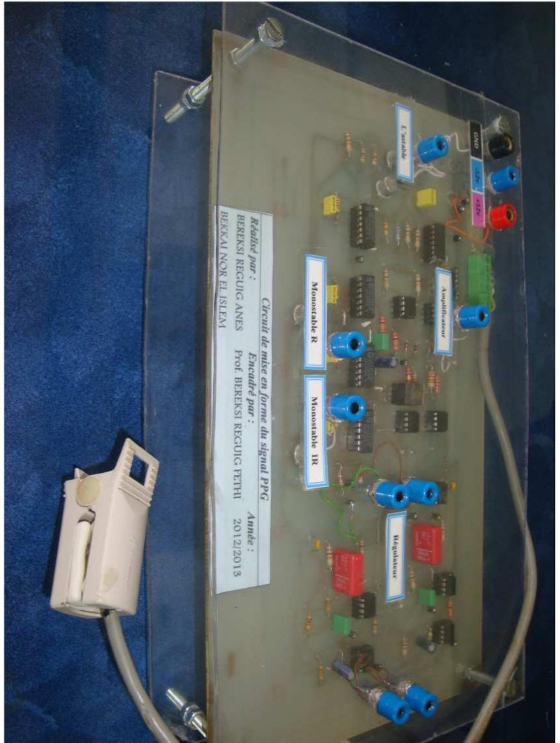
Figure 4.11 : Photo du dispositif réalisé
