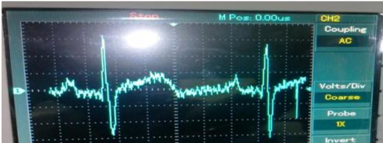
**Figure 3.2 :** Photo du signal ECG sur oscilloscope à Mémoire
