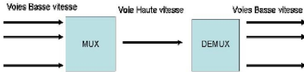
Figure I.6 : Principe de multiplexage
