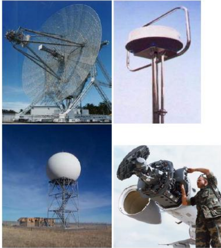
Figure I.4 : Photographies de radars conventionnels, dans le sens de lecture : radar terrestre, radar maritime embarqué, radar météorologique, radar aérien embarqué
