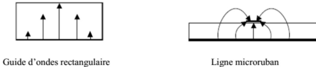
**Figure I.15:** Lignes de champs dans un guide d'onde rectangulaire et dans une ligne micro-ruban.
