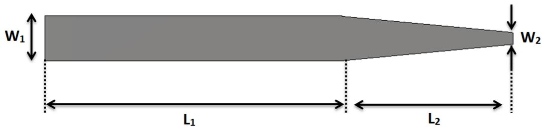
**Figure III.4:** Structure du taper du guide SIW fonctionnant en bande Ku.
