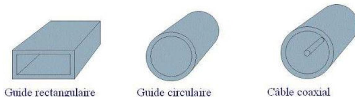
**Figure I.2:** Différentes structures de guides d'ondes.
