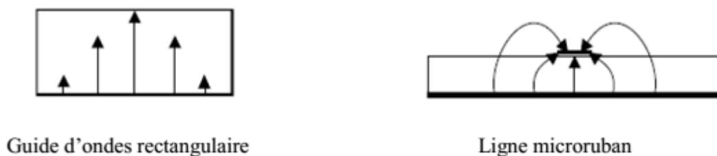
Figure I.15: Lignes de champs dans un guide d'onde rectangulaire et dans une ligne micro-ruban.
