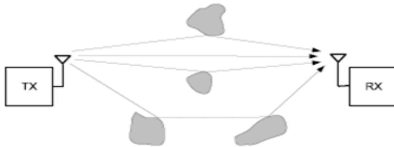
**Figure II.18:** La propagation au travers d'un canal multitrajets.
